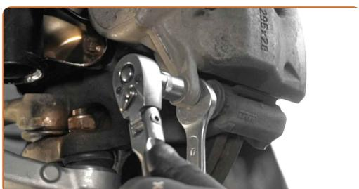
11 Entfernen Sie die Befestigungsschrauben.
