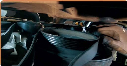
**Austausch: Keilriemen – MERCEDES-BENZ Sprinter 2-T Pritsche/Fahrgestell (W901, W902). Tipp von AUTODOC:**
