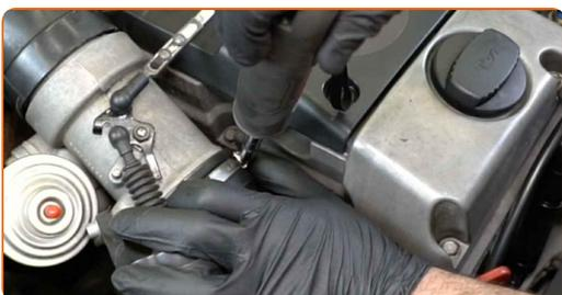
**40** Entfernen Sie den Deckel des Kühlmittelbehälters.
