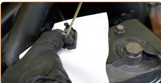
**36** Bringen Sie den Steckverbinder des Kühlmitteltemperatursensors an.
