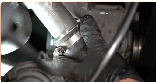
**29** Sichern Sie die Klemme des Kühlmittelschlauchs. Verwenden Sie Stecknuss Nr. 7. Verwenden Sie einen Ratschenschlüssel.
