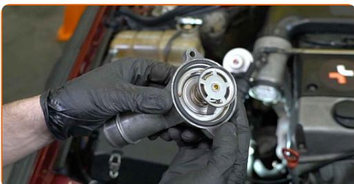
**25** Montieren Sie den Thermostat zusammen mit dem Gehäuse.
