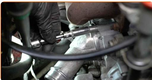
**28** Bringen Sie den Kühlmittelschlauch an.
