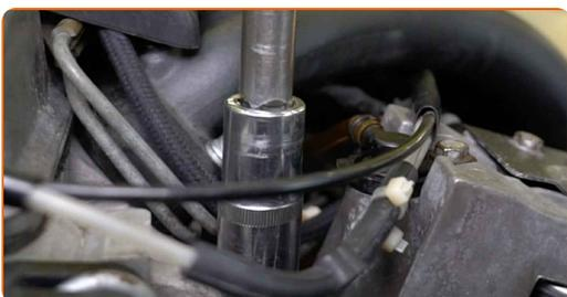
**35** Behandeln Sie den Stecker des Kühlmitteltemperatursensor. Verwenden Sie dielektrisches Fett.
