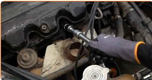
**13** Schrauben Sie die neuen Zündkerzen an und ziehen Sie diese fest. Verwenden Sie die Zündkerzennuss # 16. Verwenden Sie einen Drehmomentschlüssel. Ziehen Sie ihn mit 22 Nm Drehmoment fest.
