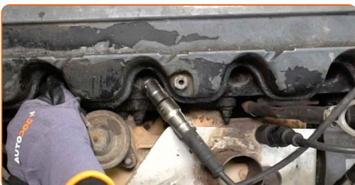
**8** Entfernen Sie Schmutz, Staub und Ablagerungen von den Zündkerzenbohrung.
