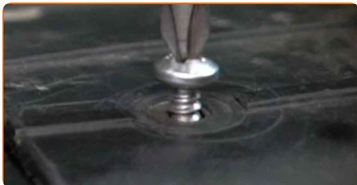
**17** Schrauben Sie die Befestigungsschrauben des Einlassrohrs ein. Verwenden Sie einen Kreuzschlitzschraubendreher. Verwenden Sie Stecknuss Nr. 10. Verwenden Sie einen Ratschenschlüssel.
