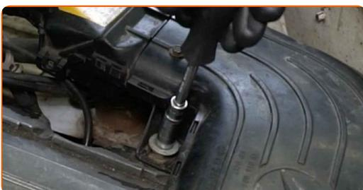
**5** Entfernen Sie die Befestigungsschrauben.
