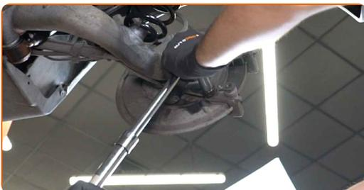
**14** Entfernen Sie die Sattelhalterung.
