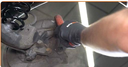
**13** Lösen Sie die Befestigung der Sattelhalterung. Verwenden Sie Stecknuss Nr. 16. Verwenden Sie ein Windeisen. Verwenden Sie einen Ratschenschlüssel.
