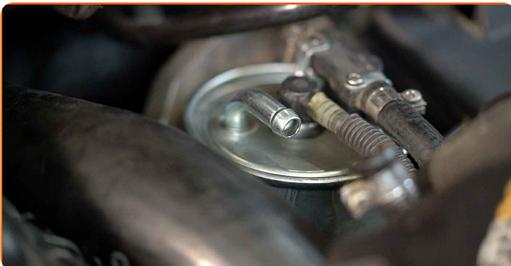
**6** Entfernen Sie den Kraftstoffdrucksensor. Benutzen Sie ein Brecheisen.
