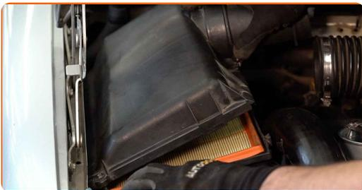
**60** Verbinden Sie das Luftansaugrohr mit dem Luftfilter-Gehäuse.
