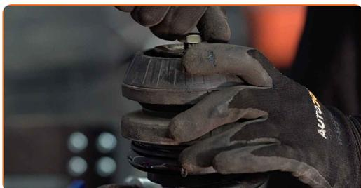
**39** Ziehen Sie die Federbeinkolbenstangenmutter an. Verwenden Sie Ring-Gabelschlüssel Nr. 21. Verwenden Sie Inbusschlüssel Nr. H6. Verwenden Sie einen Drehmomentschlüssel. Ziehen Sie ihn mit 66 Nm Drehmoment fest.
