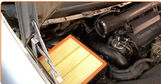
**59** Setzen Sie die Luftfilterabdeckung ein. Befestigen Sie diese.
