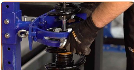
**38** Bauen Sie das Domlager und das Federbeinstützlager ein. Benutzen Sie ein Brecheisen.
