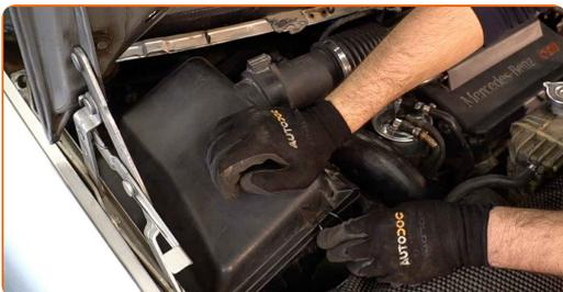
**62** Drehen Sie die Befestigungsschrauben der Luftfilter-Abdeckung ein. Verwenden Sie einen Kreuzschlitzschraubendreher.
