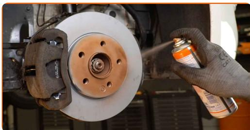
**78** Die Bremsscheibenoberfläche reinigen. Benutzen Sie einen Bremsenreiniger.
