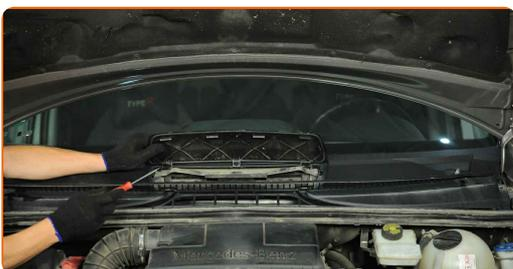
**24** Nehmen Sie den Kabinenfilterstecker heraus. Verwenden Sie den Torx T25. Verwenden Sie einen Ratschenschlüssel.
