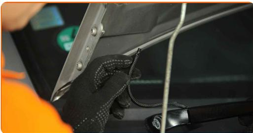
**23** Heben Sie die Windabweiserabdeckung an und entfernen Sie dieses. Verwenden Sie einen flachen Schraubendreher.
