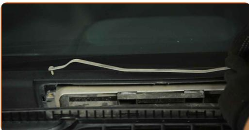
**25** Entfernen Sie die untere Windlaufabdeckung.
