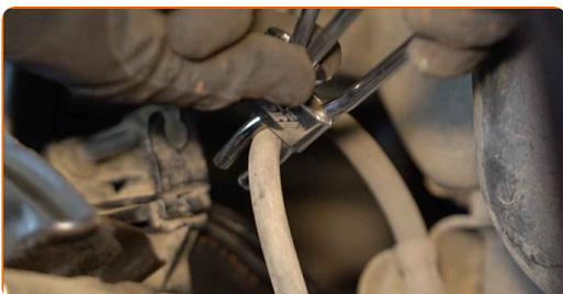
**12** Lösen Sie die Bremsschlauchbefestigung. Verwenden Sie einen offenen Ringschlüssel #14.
