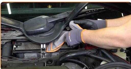
**33** Montieren Sie den mittleren Teil des Ablaufs.
