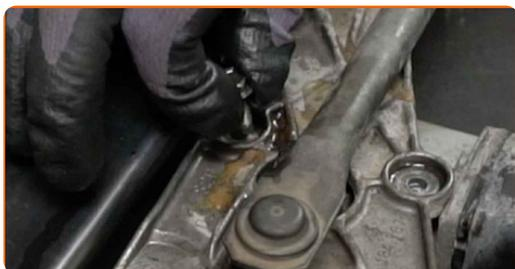
**19** Lösen Sie das Wischergestänge von der Motorwelle.
