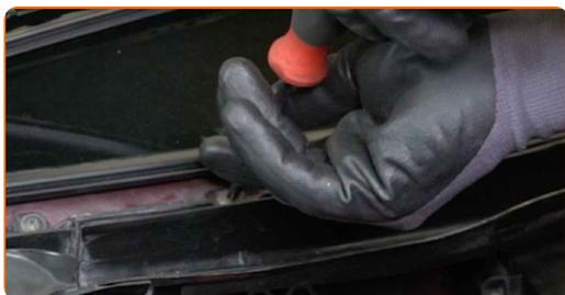
**7** Demontieren Sie die seitlichen Wasserabläufe.
