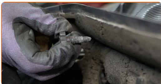
**5** Entfernen Sie das Gummiformteil der Windschutzscheibe.
