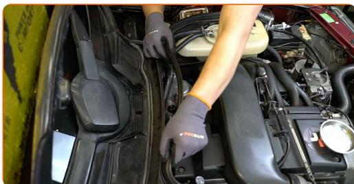
**4** Entfernen Sie das mittlere Element, das die Dichtung der Wasserkastenabdeckung hält.
