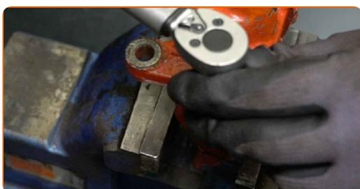
**39** Ziehen Sie die Bremsentlüftungsschraube an.
