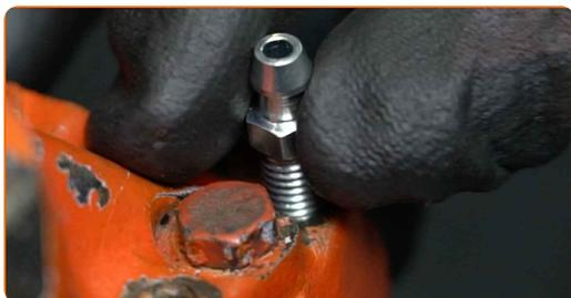
**40** Reinigen Sie den Bereich, in dem der Bremsschlauch mit dem Bremssattel verbunden ist. Benutzen Sie eine Drahtbürste. Verwenden Sie Allzweckreinigungsspray.
