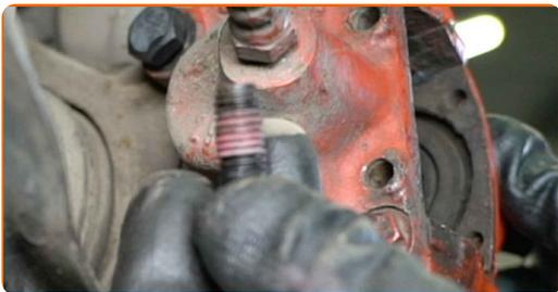
**19** Entfernen Sie den Bremssattel.
