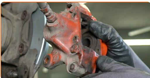
**20** Schrauben Sie den Bremschlauch vom Bremssattel ab.
