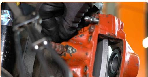
**44** Ziehen Sie die Bremssattelbefestigungen fest. Verwenden Sie Stecknuss Nr. 17. Verwenden Sie einen Drehmomentschlüssel. Ziehen Sie ihn mit 65 Nm Drehmoment fest.
