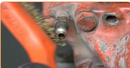
**22** Lösen Sie die Bremsentlüftungsschraube. Verwenden Sie Stecknuss Nr. 9. Verwenden Sie einen Ratschenschlüssel.
