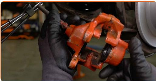
**42** Bauen Sie den Bremssattel ein und befestigen Sie diesen.
