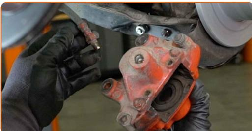
**21** Reinigen Sie die Bremsentlüftungsschraube. Benutzen Sie eine Drahtbürste. Benutzen Sie WD-40-Spray.
