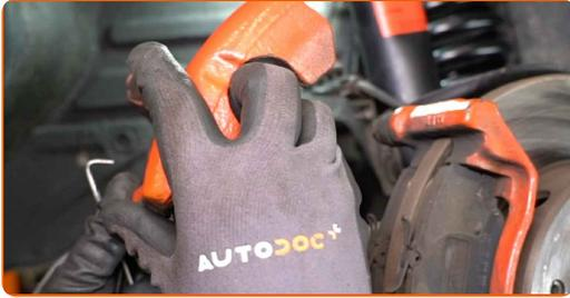
**Austausch: Bremsbeläge – MERCEDES-BENZ W124 T-modell (S124). Tipp von AUTODOC-Experten:**
