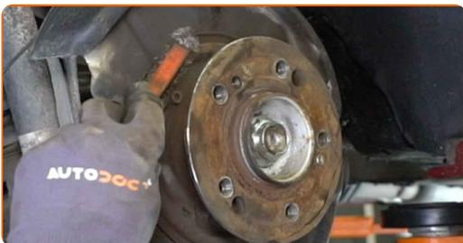
**26** Entfernen Sie den Nachsteller der Feststellbremse.
