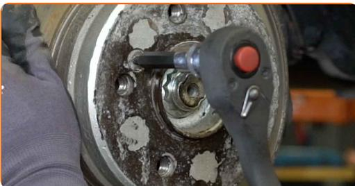
**19** Entfernen Sie die Befestigungsschraube.
