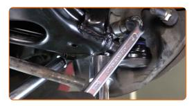
Entfernen Sie die Stütze unter dem Achsschenkel.
