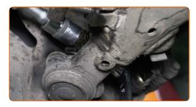
Entfernen Sie die Befestigungsschraube.
