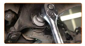
Schrauben Sie die vordere Befestigung des Querlenkers ab. Verwenden Sie Ring-Gabelschlüssel Nr. 22. Verwenden Sie Stecknuss Nr. 22. Verwenden Sie einen Ratschenschlüssel.
