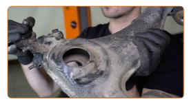
Reinigen Sie die Montagesitze des Achslenkers. Benutzen Sie eine Drahtbürste. Verwenden Sie Allzweckreinigungsspray.
