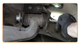
Entfernen Sie die Spiralfeder zusammen mit dem Federspanner.
