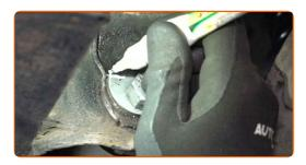
Schrauben Sie die hintere Befestigung des Querlenkers ab. Verwenden Sie Ring-Gabelschlüssel Nr. 22. Verwenden Sie Stecknuss Nr. 22. Verwenden Sie einen Ratschenschlüssel.
