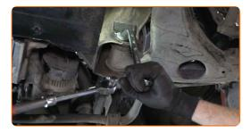
Schrauben Sie die Schraubbefestigungen, die die Schelle des Stabilisatorlagers mit dem Querlenker verbinden, ab. Verwenden Sie Stecknuss Nr. 13. Verwenden Sie einen Ratschenschlüssel.
