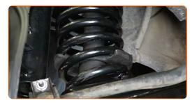
Entfernen Sie den Spiralfederspanner.
