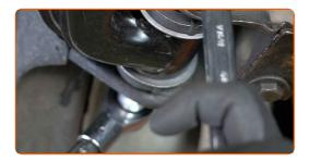
Ziehen Sie die vordere Befestigung des Lenkers fest. Verwenden Sie Ring-Gabelschlüssel Nr. 22. Verwenden Sie Stecknuss Nr. 22. Verwenden Sie einen Drehmomentschlüssel. Ziehen Sie ihn mit 120 Nm Drehmoment fest.
