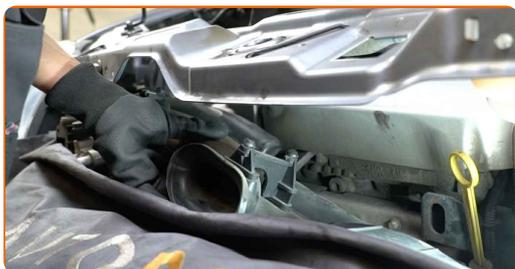
**5** Schrauben Sie das Verbindungsteil der Motorhaube ab. Verwenden Sie den Torx T30. Verwenden Sie einen Ratschenschlüssel.
