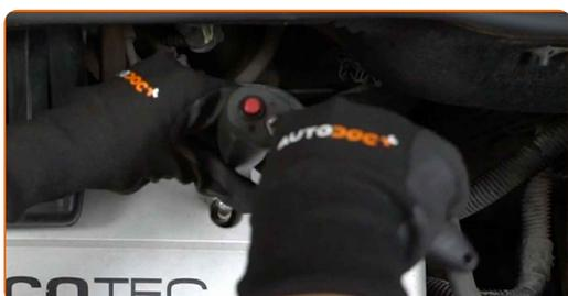
**6** Schrauben Sie die Öleinfüllschraube ab.
