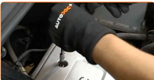
**26** Entfernen Sie das Mikrofasertuch von der Öffnung des Öleinfüllers.
