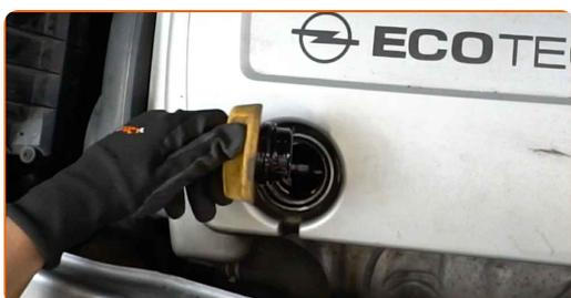
**7** Entfernen Sie die Öleinfüllschraube.
