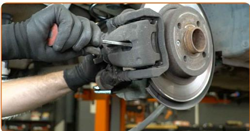
**11** Entfernen Sie den Bremssattel.
