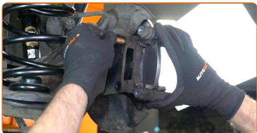
**24** Befestigen Sie die Bremssattelhalterung. Verwenden Sie Stecknuss Nr. E20. Verwenden Sie einen Drehmomentschlüssel. Ziehen Sie ihn mit 100 Nm Drehmoment fest.
