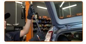
Reinigen Sie den Montagesitz des Heckklappendämpfers. Benutzen Sie WD-40-Spray.
