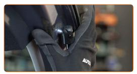
Lösen Sie den Sicherungsring, der die Gasfeder mit der Karosserie verbindet. Verwenden Sie einen flachen Schraubendreher.
