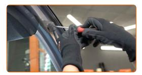
Lösen Sie den Sicherungsring, der die Gasfeder mit der Karosserie verbindet. Verwenden Sie einen flachen Schraubendreher.
