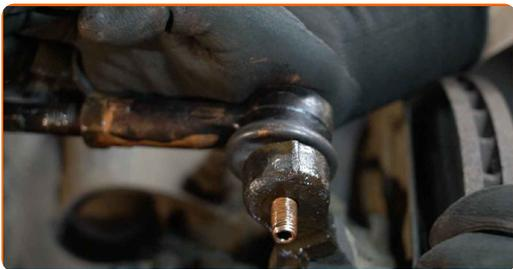
**15** Behandeln Sie das Befestigungselement, das den Spurstangenkopf mit dem Achsschenkel verbindet. Benutzen Sie ein Kupferschmiermittel.
