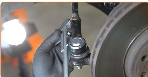
**18** Ziehen Sie die Spurstangenkopf Sicherungsmutter an. Verwenden Sie Ring-Gabelschlüssel Nr. 21 (2 Teile). Verwenden Sie einen Drehmomentschlüssel. Ziehen Sie ihn mit 55 Nm Drehmoment fest.
