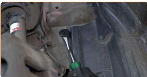
**7** Lösen Sie die Befestigungen der Spannrolle. Verwenden Sie Ring-Gabelschlüssel Nr. 14.
