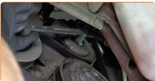
**8** Lockern Sie den Keilrippenriemen. Verwenden Sie Stecknuss Nr. 12. Verwenden Sie einen Ratschenschlüssel.
