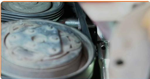
**9** Entfernen Sie den Keilrippenriemen.
