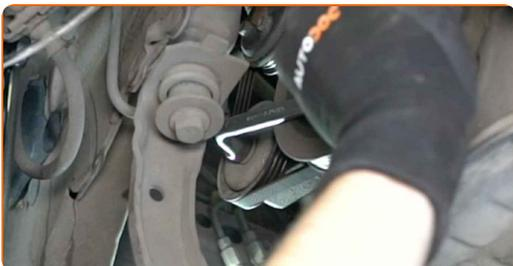
**11** Lockern Sie den Keilrippenriemen. Verwenden Sie Stecknuss Nr. 12. Verwenden Sie einen Ratschenschlüssel.
