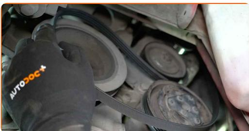
**10** Lösen Sie die Befestigungen der Spannrolle. Verwenden Sie Ring-Gabelschlüssel Nr. 14.
