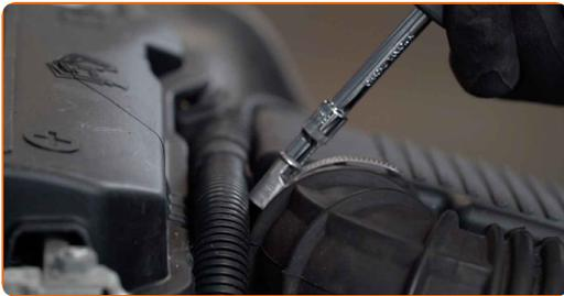
**4** Lösen Sie die Befestigungsschrauben der Luftfilter-Abdeckung. Verwenden Sie Stecknuss Nr. 8. Verwenden Sie einen Ratschenschlüssel.
