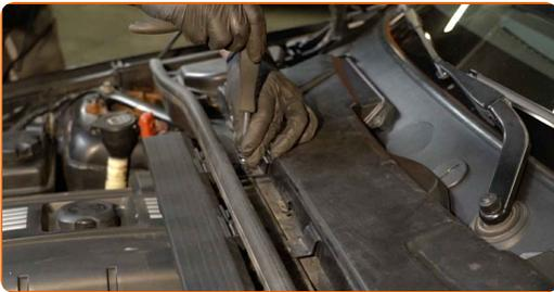
**4** Entfernen Sie den Gehäusedeckel des Innenraumfilters.
