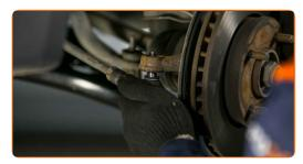
Ziehen Sie die Befestigungsmutter an, die den Spurstangenkopf mit dem Achsschenkel verbindet. Verwenden Sie Stecknuss Nr. 19. Verwenden Sie einen Drehmomentschlüssel. Ziehen Sie ihn mit 31 Nm Drehmoment fest.
