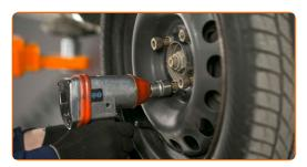
Senken Sie das Auto und ziehen Sie die Radschrauben über Kreuz an. Verwenden Sie eine Schlagnuss für Felgen # 19. Verwenden Sie einen Drehmomentschlüssel. Ziehen Sie ihn mit 118 Nm Drehmoment fest.
