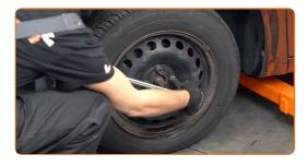
Entfernen Sie den Wagenheber sowie die Unterlegkeile.
