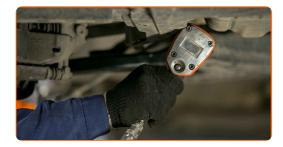
Schrauben Sie die hintere Armbefestigung an. Verwenden Sie Ring-Gabelschlüssel Nr. 21. Verwenden Sie Stecknuss Nr. 21. Verwenden Sie einen Ratschenschlüssel.
