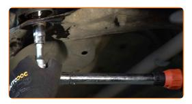
Entfernen Sie den Träger unter dem Arm.
