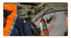
11 Entfernen Sie die Befestigungsschraube.
