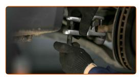
Reinigen Sie alle Gelenke der Koppelstange. Benutzen Sie eine Drahtbürste. Benutzen Sie WD-40-Spray.
