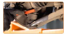
Schrauben Sie die Befestigung ab, die das Traggelenk mit dem Achsschenkel verbindet. Verwenden Sie Ring-Gabelschlüssel Nr. 18.
