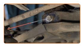
Schrauben Sie die vordere Armbefestigung ab. Verwenden Sie Ring-Gabelschlüssel Nr. 21. Verwenden Sie Stecknuss Nr. 21. Verwenden Sie einen Ratschenschlüssel.
