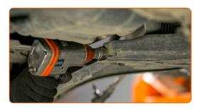
Entfernen Sie die vordere Befestigung des Querlenkers.
