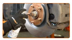
Die Bremsscheibenoberfläche reinigen. Benutzen Sie einen Bremsenreiniger.
