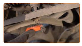
Befestigen Sie die Stabilisatorstange. Verwenden Sie Ring-Gabelschlüssel Nr. 13. Verwenden Sie Stecknuss Nr. 13. Verwenden Sie einen Ratschenschlüssel.
