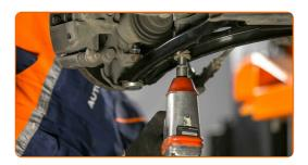
Bauen Sie den Spurstangenkopf an dem Achsschenkel an.
