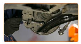
Ziehen Sie das vordere Befestigungselement an, das den Querlenker mit dem Hilfsrahmen verbindet. Verwenden Sie Ring-Gabelschlüssel Nr. 21. Verwenden Sie Stecknuss Nr. 21. Verwenden Sie einen Drehmomentschlüssel. Ziehen Sie ihn mit 145 Nm Drehmoment fest.
