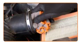
Entfernen Sie das Filterelement aus dem Filtergehäuse.
