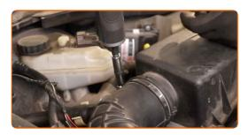
Trennen Sie das Luftkanal-Gehäuse vom Luftfilter-Gehäuse.
