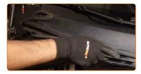
Schrauben Sie die Befestigungen der Windlaufabdeckung an, die sich auf der rechten Seite befindet. Verwenden Sie den Torx T30. Verwenden Sie einen Ratschenschlüssel.
