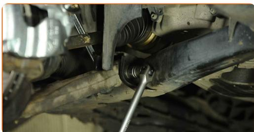
**12** Entfernen Sie die vordere Befestigung des Querlenkers.
