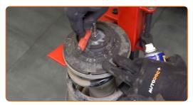
Entfernen Sie die Stangenmutter des Federkolben. Verwenden Sie Ring-Gabelschlüssel Nr. 21. Verwenden Sie Inbusschlüssel Nr. H7. Verwenden Sie einen Ratschenschlüssel.
