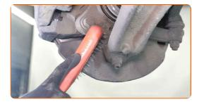
Schrauben Sie die Befestigungen des Kugelgelenks vom Achsschenkel ab. Verwenden Sie Stecknuss Nr. 19. Verwenden Sie einen Ratschenschlüssel.
