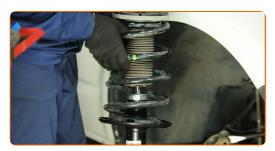
Schrauben Sie die obere Befestigung des Domlagers an.
