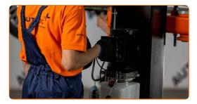
Lösen Sie das untere Befestigungselement, dass das Federbein mit dem Achsschenkel verbindet. Verwenden Sie einen flachen Metallmeißel. Benutzen Sie einen Hammer.
