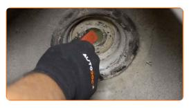
61 Installieren Sie das Federbein am Radlauf.
