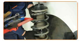
42 Stellen Sie das Dämpferbein auf das Federspannwerkzeug.
