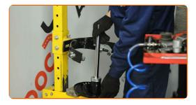
Installieren Sie die Feder am Stoßdämpfer.
