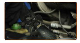
Trennen Sie das Luftansaugrohr vom Luftfilter-Gehäuse.
