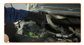
74 Entfernen Sie die Kotflügel-Abdeckung.
