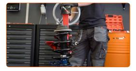
Entfernen Sie das zusammengebaute Federbein.
