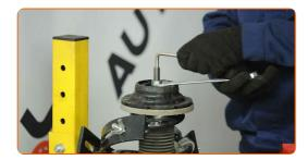
Dekomprimieren Sie die Feder.
