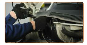
Schrauben Sie die Befestigungsschrauben der Schutzabdeckung fest. Verwenden Sie den Torx T30. Verwenden Sie einen Ratschenschlüssel.
