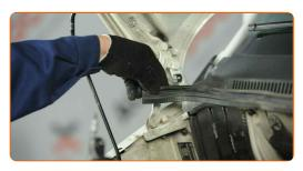
Schrauben Sie die Befestigungsschrauben der Schutzabdeckung ab. Verwenden Sie den Torx T30. Verwenden Sie einen Ratschenschlüssel.
