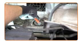
Lösen Sie die obere Befestigung des Domlagers. Verwenden Sie Ring-Gabelschlüssel Nr. 21. Verwenden Sie Inbusschlüssel Nr. H7. Verwenden Sie einen Ratschenschlüssel.
