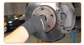
Die Antriebswellenmutter festziehen. Verwenden Sie Stecknuss Nr. 30. Verwenden Sie einen Drehmomentschlüssel. Ziehen Sie ihn mit 200 Nm Drehmoment fest.
