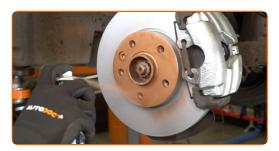
Die Bremsscheibenoberfläche reinigen. Benutzen Sie einen Bremsenreiniger.
