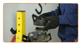
Ziehen Sie die Federbeinkolbenstangenmutter an. Verwenden Sie Stecknuss Nr. 21. Verwenden Sie Inbusschlüssel Nr. H7. Verwenden Sie einen Drehmomentschlüssel. Ziehen Sie ihn mit 80 Nm Drehmoment fest.
