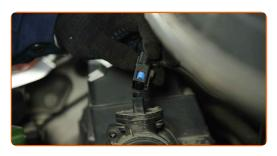
Lösen Sie die Befestigungsclips der Luftfilterabdeckung.
