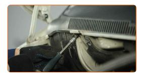
Entfernen Sie die Schutzabdeckung.
