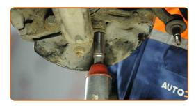
Ziehen Sie die unteren Befestigungen an, die das Federbein mit dem Achsschenkel verbinden. Verwenden Sie Stecknuss Nr. 18. Verwenden Sie einen Drehmomentschlüssel. Ziehen Sie ihn mit 75 Nm Drehmoment fest.+180°
