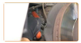
Schrauben Sie die Befestigungen ab, die das Federbein mit dem Achsschenkel verbinden. Verwenden Sie Stecknuss Nr. 18. Verwenden Sie einen Ratschenschlüssel.
