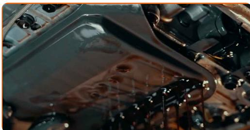
**8** Reinigen Sie die Wanne und die Magnete. Bereiten Sie die Kontaktflächen des Getriebegehäuses und der Getriebeölwanne vor: Entfernen Sie das alte Dichtmittel und entfetten Sie die Oberfläche.
