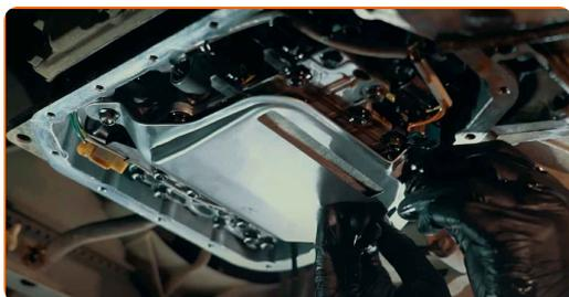
**10** Setzen Sie eine neue Getriebeölwannendichtung ein.
