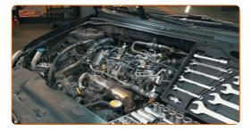
Öffnen Sie die Motorhaube und nehmen Sie die Motorabdeckung ab
