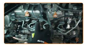
Verwenden Sie zum Abschrauben der Glühkerzen einen Drehmomentschlüssel mit einer geeigneten Stecknuss
