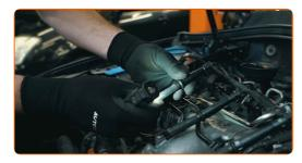
Ziehen Sie die Schraubverbindung der gemeinsamen Stromversorgung mit dem vom Fahrzeughersteller empfohlenen Drehmoment an
