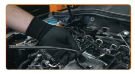
Wenn das voreingestellte Drehmoment nicht ausreicht, um die Glühkerzen herauszuschrauben, können Sie Folgendes versuchen: Entfernen Sie die Teile, nachdem Sie den Motor auf Betriebstemperatur gebracht haben
