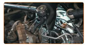
Stellen Sie den Schlüssel auf das vom Fahrzeughersteller empfohlene Drehmoment ein. Dieser Wert kann auf der Verpackung oder im Reparaturhandbuch des Fahrzeugs angegeben sein
