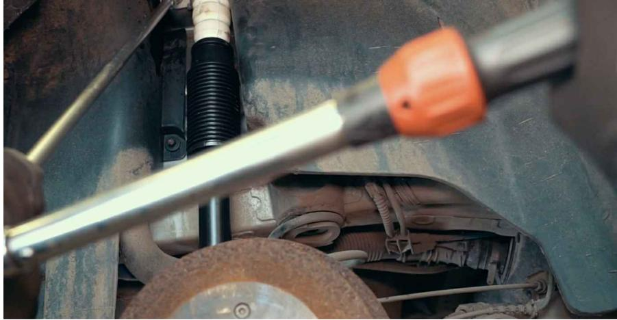
Austausch der Staubmanschette und des Anschlagpuffers an einem Federbein
