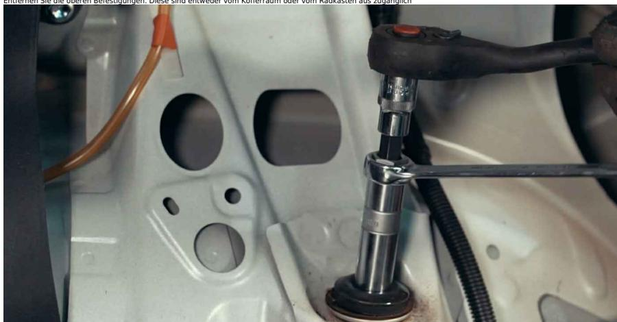
Austausch der Staubmanschette und des Anschlagpuffers bei einem Stoßdämpfer, der getrennt von der Feder montiert ist
