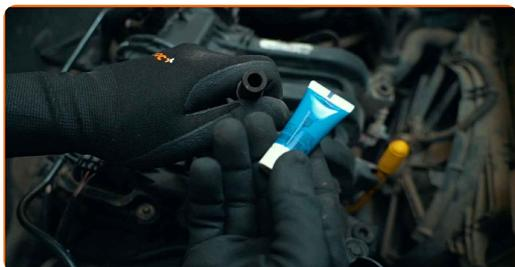
**15** Sorgen Sie dafür, dass kein dielektrisches Fett auf die Elektroden gelangt, um Fehlfunktionen in der Zündanlage zu vermeiden.
