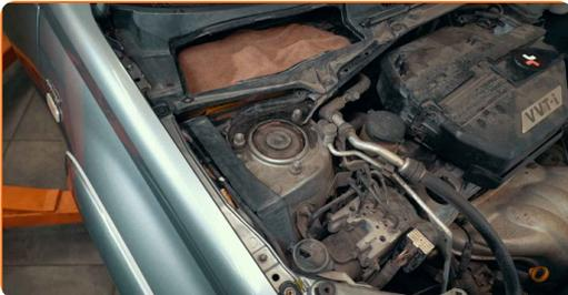
**2** Schrauben Sie sie nicht vollständig ab, sondern lösen Sie sie nur, während das Fahrzeug noch auf dem Boden steht, oder falls es aufgebockt wurde, heben Sie die Radbaugruppe an und stützen Sie sie ab.
