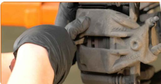
**12** Entfernen Sie den Bremssattel.
