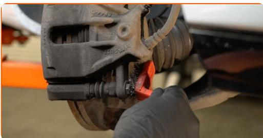
**10** Schrauben Sie die Befestigung des Bremssattels ab. Verwenden Sie Ring-Gabelschlüssel Nr. 13. Verwenden Sie Ring-Gabelschlüssel Nr. 19.
