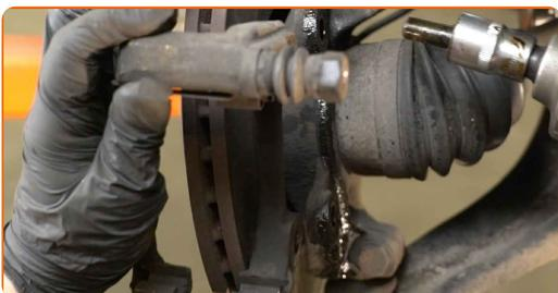
**17** Reinigen Sie die Befestigungselemente der Bremsscheibe. Benutzen Sie eine Drahtbürste. Benutzen Sie WD-40-Spray.
