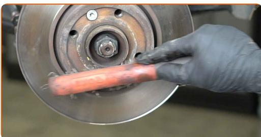
**18** Lösen Sie die Befestigung der Bremsscheibe. Verwenden Sie den Torx T30. Verwenden Sie einen Ratschenschlüssel.
