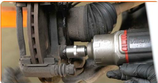
**16** Entfernen Sie die Sattelhalterung.
