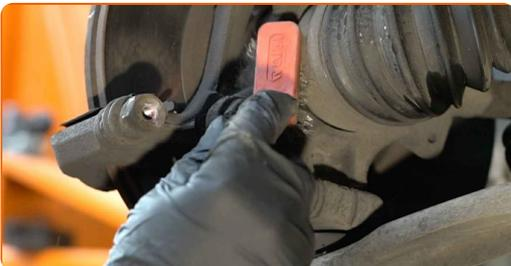
**15** Lösen Sie die Befestigung der Sattelhalterung. Verwenden Sie Stecknuss Nr. 18. Verwenden Sie ein Windeisen.
