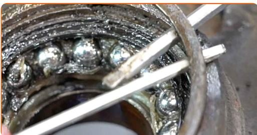
**51** Drücken Sie das Radnabenlager heraus. Druckstücksatz, Ein-/Auspresswerkzeug.
