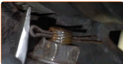
**71** Ziehen Sie die unteren Befestigungen an, die das Federbein mit dem Achsschenkel verbinden. Verwenden Sie Ring-Gabelschlüssel Nr. 17. Verwenden Sie Stecknuss Nr. 19. Verwenden Sie einen Drehmomentschlüssel. Ziehen Sie ihn mit 140 Nm Drehmoment fest.
