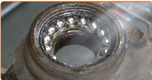
**50** Entfernen Sie den Sicherungsring am Radnabenlager. Verwenden Sie einen flachen Schraubendreher.
