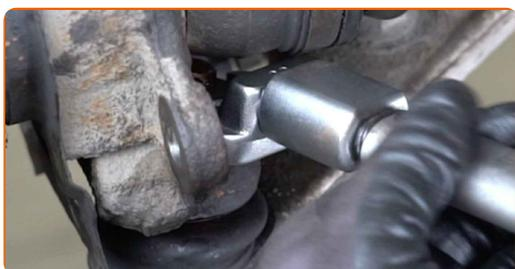
**70** Montieren Sie den Sicherungsstift, der die Befestigung fixiert, die das Kugelgelenk mit dem Achsschenkel verbindet. Benutzen Sie ein Brecheisen.
