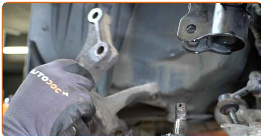
**46** Reinigen Sie den Sicherungsring des Radnabenlagers. Benutzen Sie eine Drahtbürste. Benutzen Sie WD-40-Spray.
