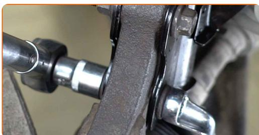
**72** Reinigen Sie die Nabe. Benutzen Sie eine Drahtbürste.
