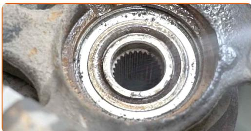
**47** Entfernen Sie den Sicherungsring am Radnabenlager. Verwenden Sie einen flachen Schraubendreher.
