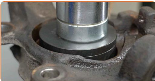
**52** Reinigen Sie den Einbauort für die Nabenlagerung. Benutzen Sie eine Drahtbürste. Benutzen Sie WD-40-Spray.
