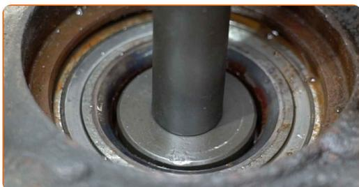
**49** Reinigen Sie den Sicherungsring des Radnabenlagers. Benutzen Sie eine Drahtbürste. Benutzen Sie WD-40-Spray.
