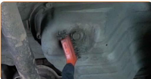
**8** Schrauben Sie die Ablassschraube heraus. Verwenden Sie Stecknuss Nr. 14. Verwenden Sie einen Ratschenschlüssel.
