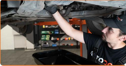
Austausch: Motoröl und Ölfilter – NISSAN Tiida Schrägheck (C12). Fachleute empfehlen:
