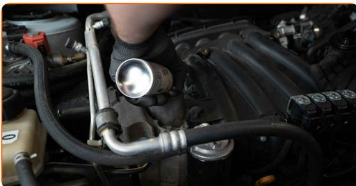
**4** Installieren Sie den Öleinfülldeckel.
