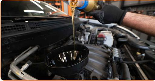
**Austausch: Motoröl und Ölfilter – NISSAN Tiida Schrägheck (C12). Tipp:**
