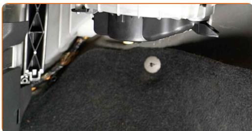
**12** Entfernen Sie den Gehäusedeckel des Innenraumfilters.
