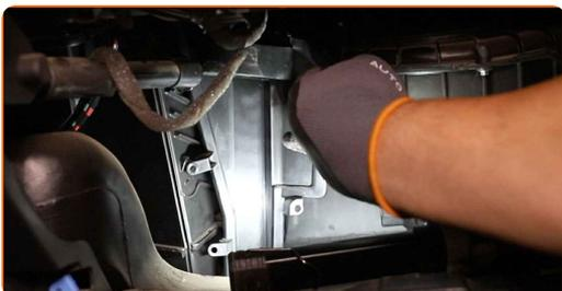
**14** Schrauben Sie die Verbindungselemente der Innenfilter-Gehäuseabdeckung ein. Verwenden Sie Stecknuss Nr. 5.5. Verwenden Sie einen Ratschenschlüssel.
