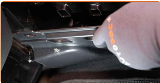
9 Schrauben Sie die Verbindungselemente der Innenfilter-Gehäuseabdeckung ab. Verwenden Sie Stecknuss Nr. 5.5. Verwenden Sie einen Ratschenschlüssel.
