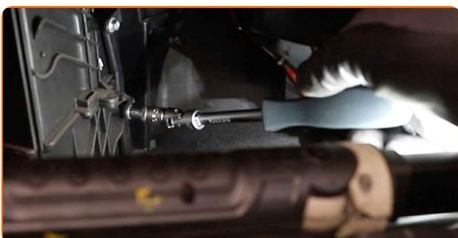
10 Entfernen Sie die Kabinenfilterabdeckung.
