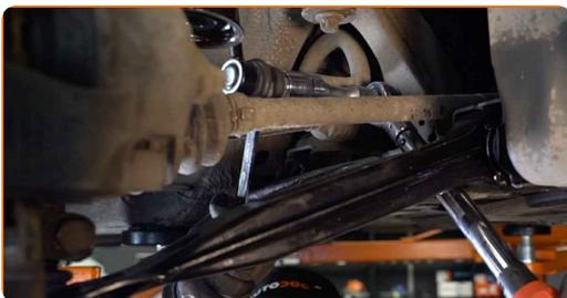
**11.2** Verwenden Sie Ring-Gabelschlüssel Nr. 19. Verwenden Sie Stecknuss Nr. 18. Verwenden Sie einen Drehmomentschlüssel. Ziehen Sie ihn mit 65 Nm Drehmoment fest.
