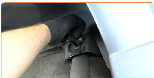
**12** Den Stoßdämpfer entfernen.
