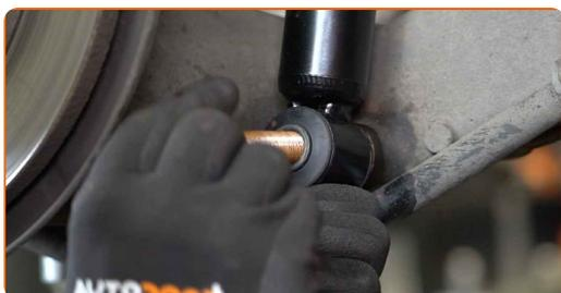
**18** Schrauben Sie das untere Befestigungselement des Stoßdämpfers ein. Verwenden Sie Stecknuss Nr. E20. Verwenden Sie einen Ratschenschlüssel.
