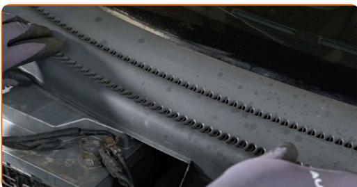
**24** Bauen Sie das Windabweiserabdeckung ein und sichern Sie diese. Verwenden Sie Stecknuss Nr. 8. Verwenden Sie einen Ratschenschlüssel. Verwenden Sie einen Kreuzschlitzschraubendreher.
