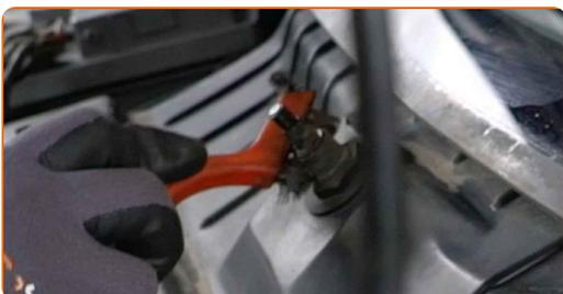
**12** Schrauben Sie die Befestigung der Kunststoffplatte ab. Verwenden Sie Ring-Gabelschlüssel Nr. 24.
