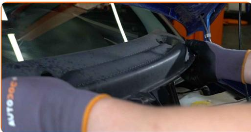
**10** Entfernen Sie die Dichtung der Windabweiserabdeckung.
