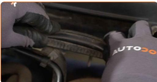
**26** Entfernen Sie die Kotflügel-Abdeckung.
