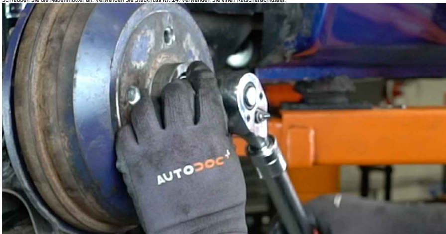
47 Schrauben Sie die Radbolzen fest. Verwenden Sie eine Schlagnuss für Felgen # 17.
