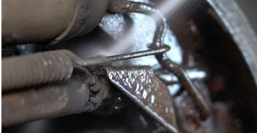
13 Lösen Sie den Nachsteller der Bremsbacken. Benutzen Sie ein Brechseisen.
