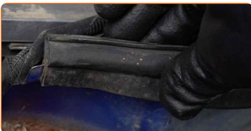
**11** Reinigen Sie die Befestigung der Kunststoffplatte. Benutzen Sie eine Drahtbürste. Benutzen Sie WD-40-Spray.
