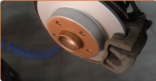
21 Die Bremsscheibenoberfläche reinigen. Benutzen Sie einen Bremsenreiniger.
