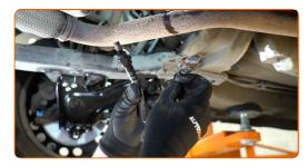
Schneiden Sie das Gewinde für die neue Lambdasonde. Verwenden Sie einen Gewindebohrer. Verwenden Sie einen Ratschenschlüssel.
