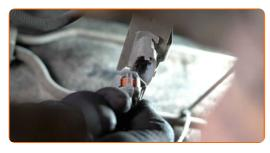
Reinigen Sie die Befestigung der Lambdasonde. Benutzen Sie eine Drahtbürste. Benutzen Sie WD-40-Spray.
