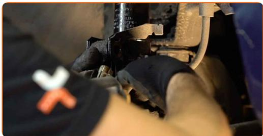
**34** Die neuen Achsschenkelschrauben einbauen.
