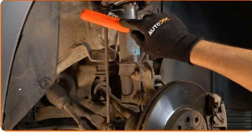
**14** Schrauben Sie die Mutter ab und entfernen Sie die Stabilisatorstange aus dem Federbein. Verwenden Sie Ring-Gabelschlüssel Nr. 19. Verwenden Sie Stecknuss Nr. 19. Verwenden Sie einen Ratschenschlüssel.
