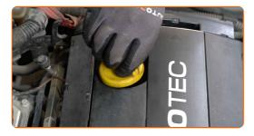
Befestigen Sie den Deckel des Öleinfüllstutzens.
