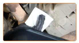
Schrauben Sie die neue Ablassschraube ein und ziehen Sie sie fest. Verwenden Sie den Torx T45. Verwenden Sie einen Drehmomentschlüssel. Ziehen Sie ihn mit 14 Nm Drehmoment fest.
