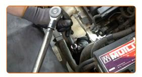
Entfernen Sie die Öleinfüllschraube.
