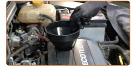
Füllen Sie neues Öl in der vom Fahrzeughersteller empfohlenen Menge in den Motor ein.
