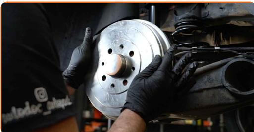
**20** Ziehen Sie die Halteklammern der Bremstrommeln an. Verwenden Sie den Torx T30. Verwenden Sie einen Drehmomentschlüssel. Ziehen Sie ihn mit 4 Nm Drehmoment fest.
