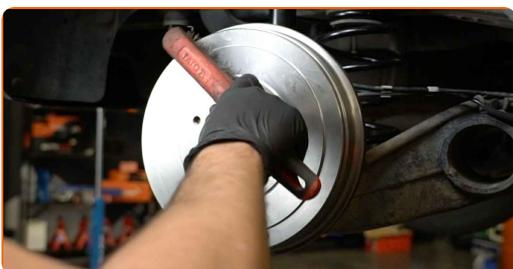
**22** Behandeln Sie die Oberfläche, an der die Radfelge die Bremstrommel berührt. Benutzen Sie ein Kupferschmiermittel.
