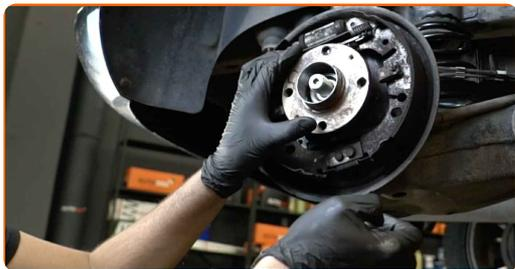
**12** Entfernen Sie die Nabe und das Lager zusammen, da sie eine versiegelte Einheit sind.
