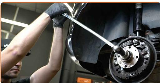
**11** Entfernen Sie die Befestigungsmutter.
