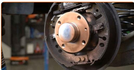
**19** Installieren Sie eine Bremstrommel.
