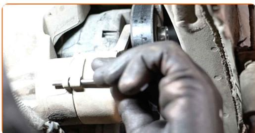
**5** Entfernen Sie den Keilrippenriemen.
